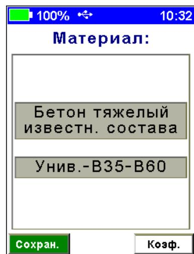
**«Коэф.»** - Установка индивидуальных калибровочных коэффициентов для выбранного состава материала и измеряемого параметра.
