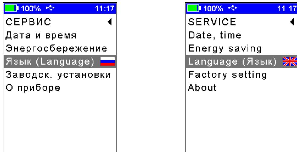
«Дата и время» - Установка даты, времени и коррекция хода внутренних часов прибора.
