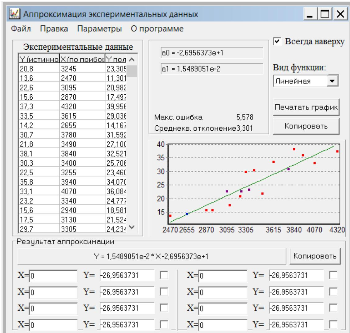
Для внесения в прибор рассчитанных значений коэффициентов градуировочной зависимости в пункте главного меню **«Материал»** выбрать и нажать программную кнопку **«Коэфты»** и установить (или изменить) значения коэффициентов градуировочной зависимости, связывающие измеряемый параметр (прочность **R**, плотность **ρ**, модуль упругости **E**, звуковой индекс **C**) со скоростью ультразвука.
