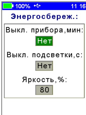
**Примечание** - При выборе значения яркости дисплея следует иметь в виду, что при увеличении яркости возрастает потребляемая мощность прибора и, следовательно, снижается время работы от аккумулятора. Продолжительность работы до разряда аккумулятора при яркости 30% больше, чем при 100% примерно в два раза. Не рекомендуется устанавливать значение яркости дисплея более 80%, т.к., в данном случае, при незначительном увеличении яркости значительно увеличивается потребление энергии прибором.
