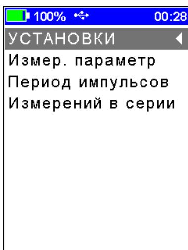
**«Измер. параметр»** - Выбор измеряемого прибором параметра и его размерности (например, параметр - «**Прочность**», размерность - «**МПа**») (для режима поверхностного прозвучивания).
