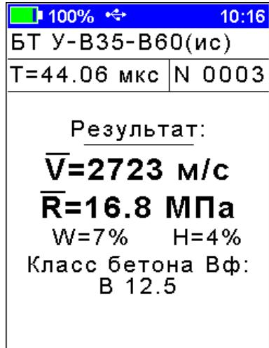
Для сохранения результата в память прибора (архив), следует нажать кнопку при этом на индикаторе появляется сообщение «**Сохранение...**». После сохранения результата прибор автоматически начнёт новую серию измерений.
