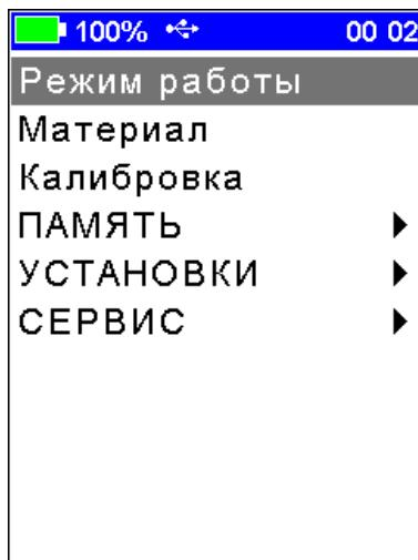
В верней части дисплея прибора во всех режимах работы выводится строка статуса, в которой отображается состояние заряда встроенного аккумулятора, подключение к USB-порту компьютера или к внешнему источнику питания, текущее время.
