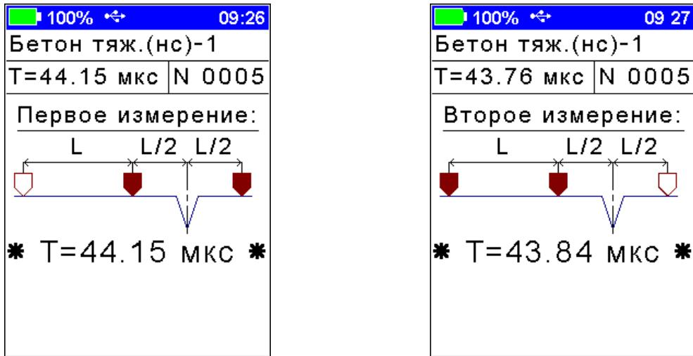
Затем нажать кнопку (для фиксации первого этапа измерения), переместить датчики согласно новой схеме и выполнить второе измерение. После очередного нажатия кнопки на дисплее выводится время первого и второго измерения в мкс и рассчитанное значение глубины трещины.
