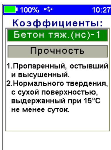
Формула, по которой будет производиться пересчет скорости ультразвука в значение прочности, доступна по нажатию программной кнопки «**Формула**».
